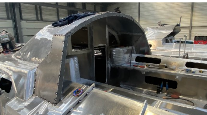
Das Cockpit auch aus Alu, nicht abklappbar / Auf die Isolation wird grossen Wert gelegt
