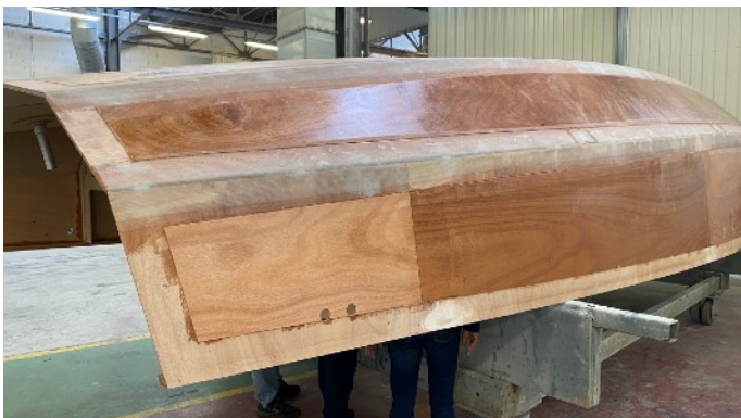
Rumpf mit abgedeckten und verstärkten Kanten
