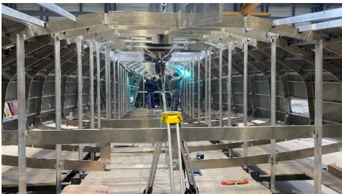
Rumpffinneres: Zuerst werden nur Punkte geschweisst, erst im 2. Arbeitsgang die ganze Naht
