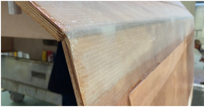
Rumpf mit Glasfaser und Epoxy bearbeitet
