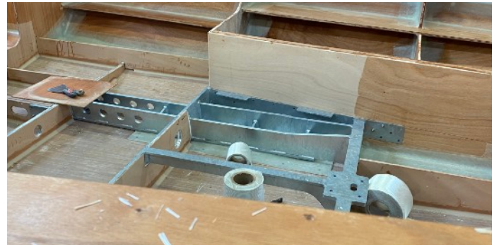
Metallverstärkung im Rumpf eingesetzt
