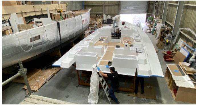
Bau des Decks aus Kunststoff
