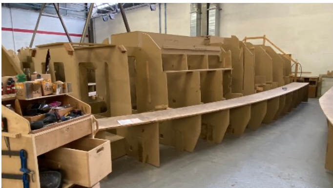
1. RM: Holzgestell (Schablone) für Bau des Rumpfs
