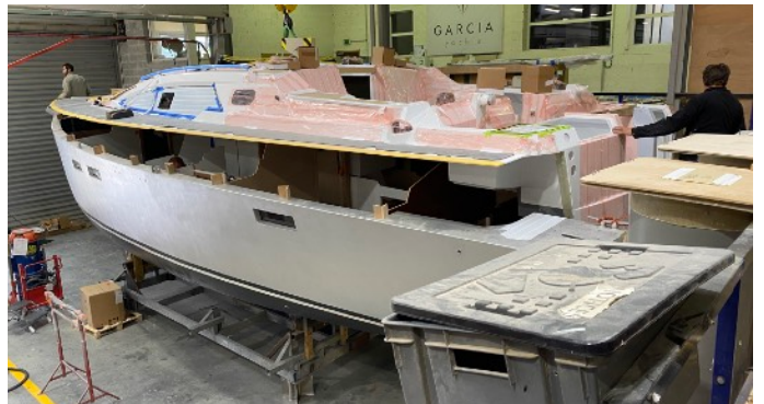
Zusammenfügen Alurumpf und Kunststoffdeck
