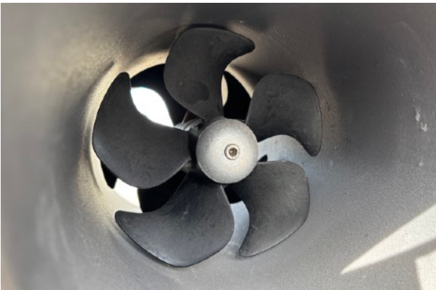
Elektrisches im Rumpf eingebautes Bugstrahlruder.
